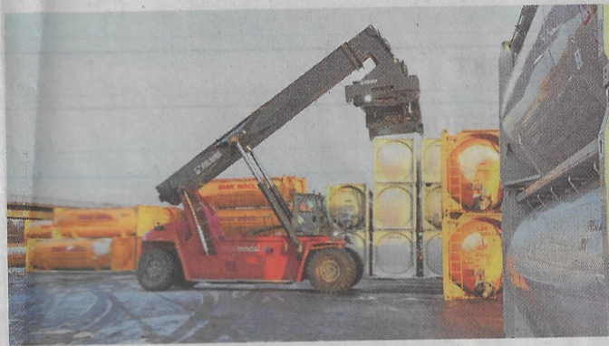
Am Terminal für den kombinierten Güterverkehr Schiene/Straße verladen Greifstapler die von Lkw angelieferten Container auf die Bahn.
